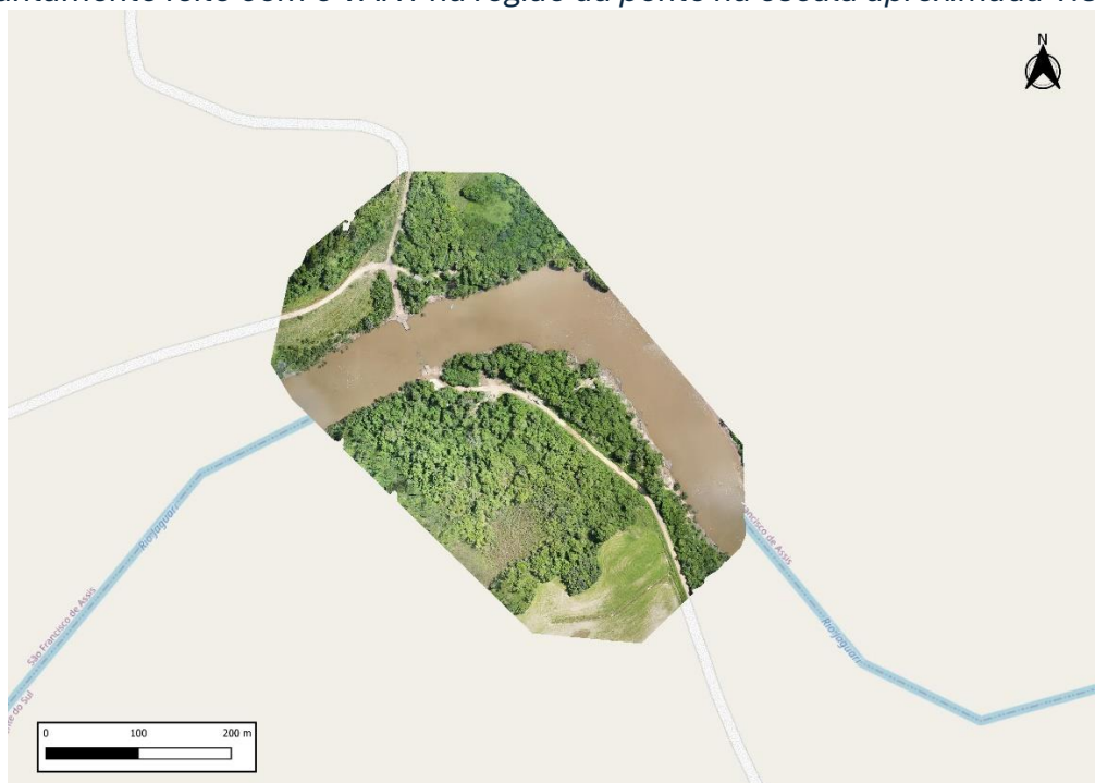
Figura 12. Ortomosaico da região da ponte do Passo da França, obtido a partir do levantamento feito com o VANT na região da ponte na escala aproximada 1:3000.
