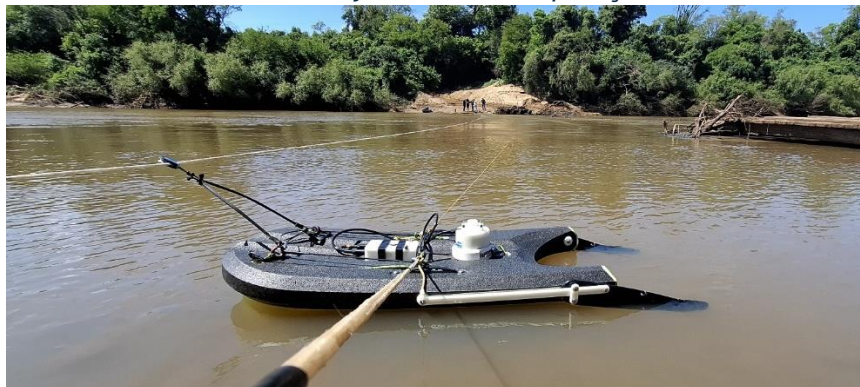
Figura 14. Imagem captada durante a batimetria da região da ponte do Passo da França, com o ADCP em conjunto com a aquisição de dados do GNSS.
